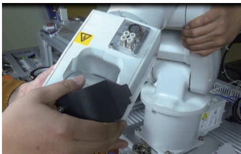
图 6-22 利用制动闸释放按钮拖动工业机器人本体
