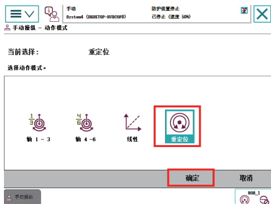
图 6-15 动作模式设定重定位运动
