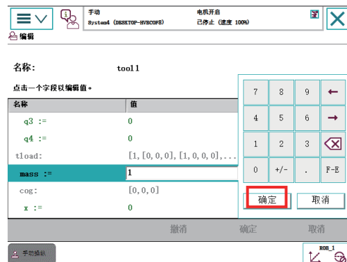
图 7-20 修改工具的质量示例
