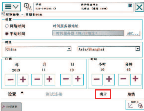
图 5-10 完成示教器时间的设置
