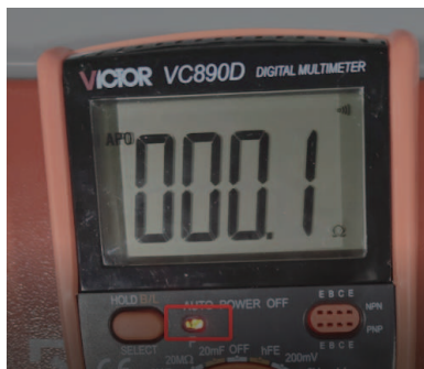
图 4-8 接线无断路时万用表显示
