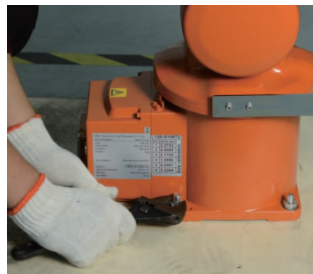
图 2-6 拆卸工业机器人本体底座处紧固件
