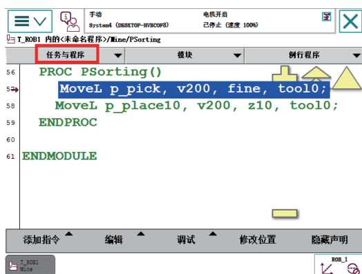
图 9-2 在“程序编辑器”内单击“任务与程序”
