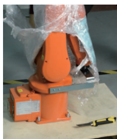
图 2-5 拆除工业机器人本体外包装
