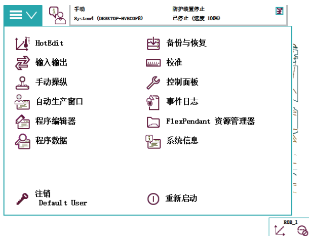
图 5-2 示教器的操作界面
