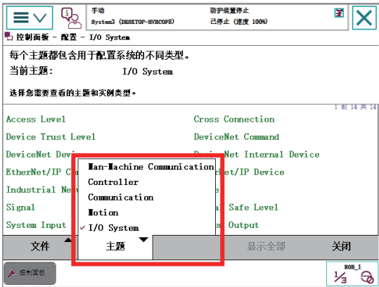
图 8-42 配置参数对应的 5 个主题
