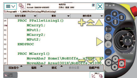
图 9-13 按压“前进一步”按钮逐步运行搬运码垛程序
