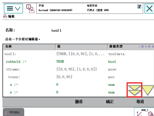
图 7-19 进行工具数据的设置
