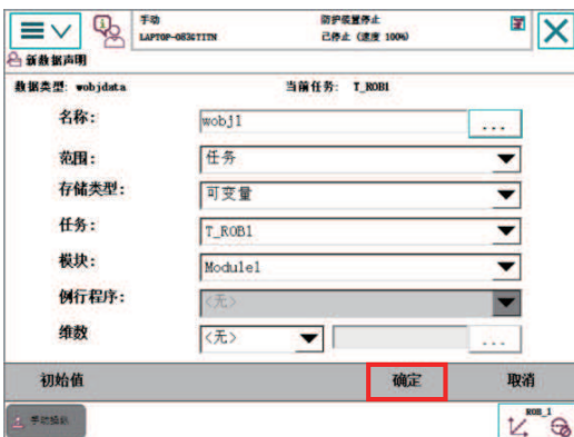
图 7-26 新建一个工件坐标系“wobj1”
