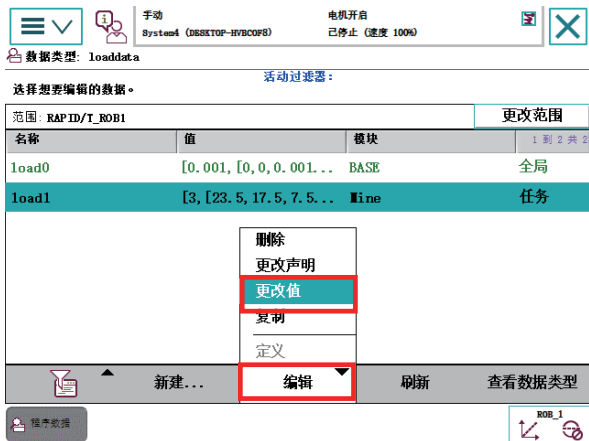
图 7-38 打开负载数据的更改值界面
