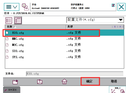
图 8-21 选择所需导入的配置参数文件
