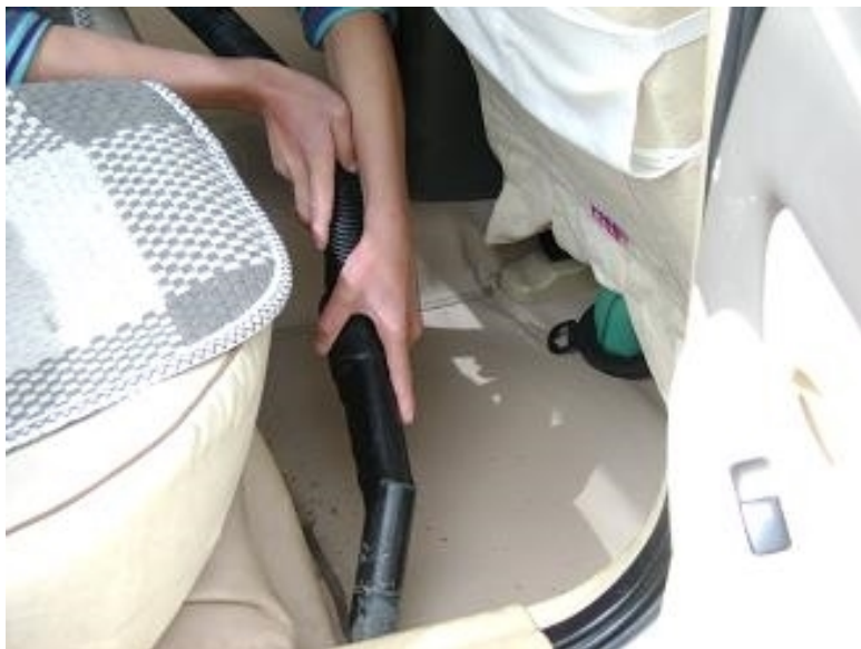
图6-54 后部乘客区除尘吸尘
