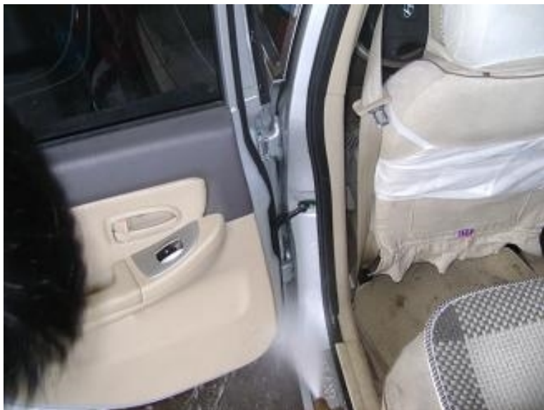
图6-49 冲洗B柱和左后门缝
