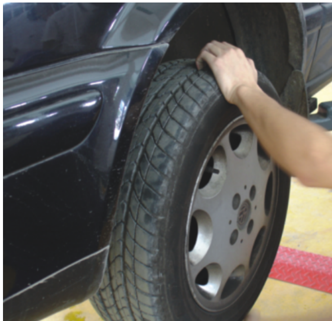
图4-50 检查车轮有无摆动、转动是否良好且无噪声
