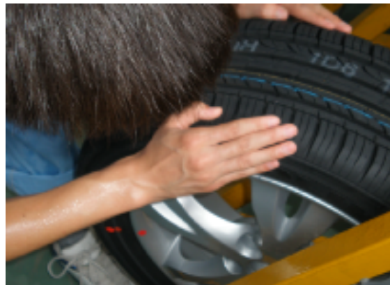
图4-44 检查胎肚及胎肩情况
