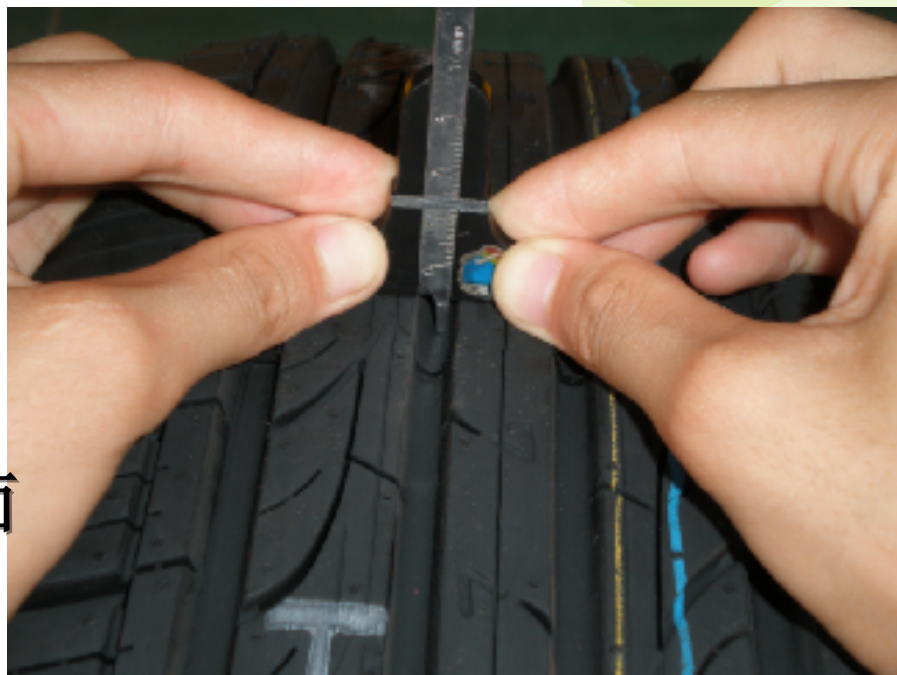
图4-47 检查轮胎胎面花纹沟槽深度
