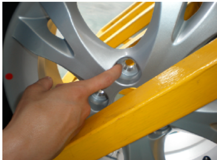
图4-49 检查轮胎螺栓孔的情况
