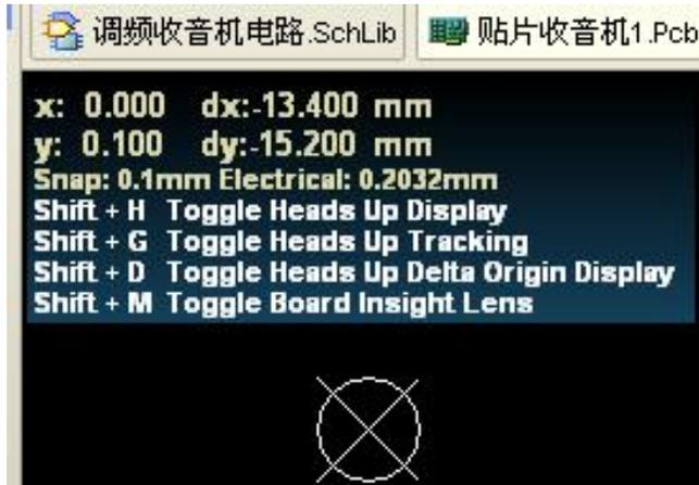
图4-40 零点的放置
