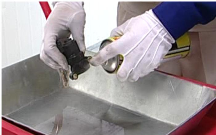
图3-9 怠速控制执行器清洗
