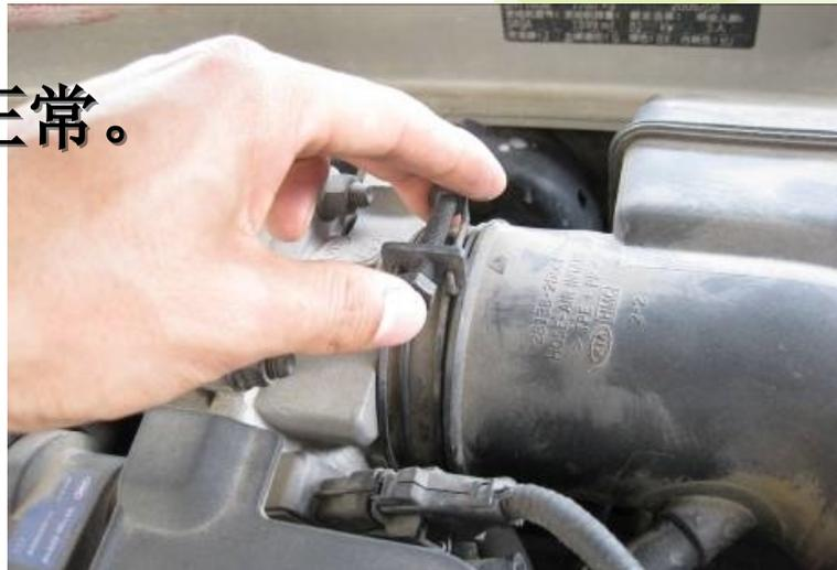
❖ 2) 用手转动节气门，观察节气门是否有卡滞或脏堵；如发现节气门存在脏堵现象，需要拆下节气门总成，再利用清洗剂进行清洗。
