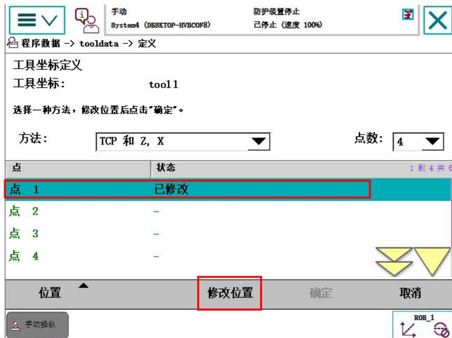
(10) 参考点1示教方法，移动工具TCP到位置2（如下图所示），完成点2的示教和定义。
