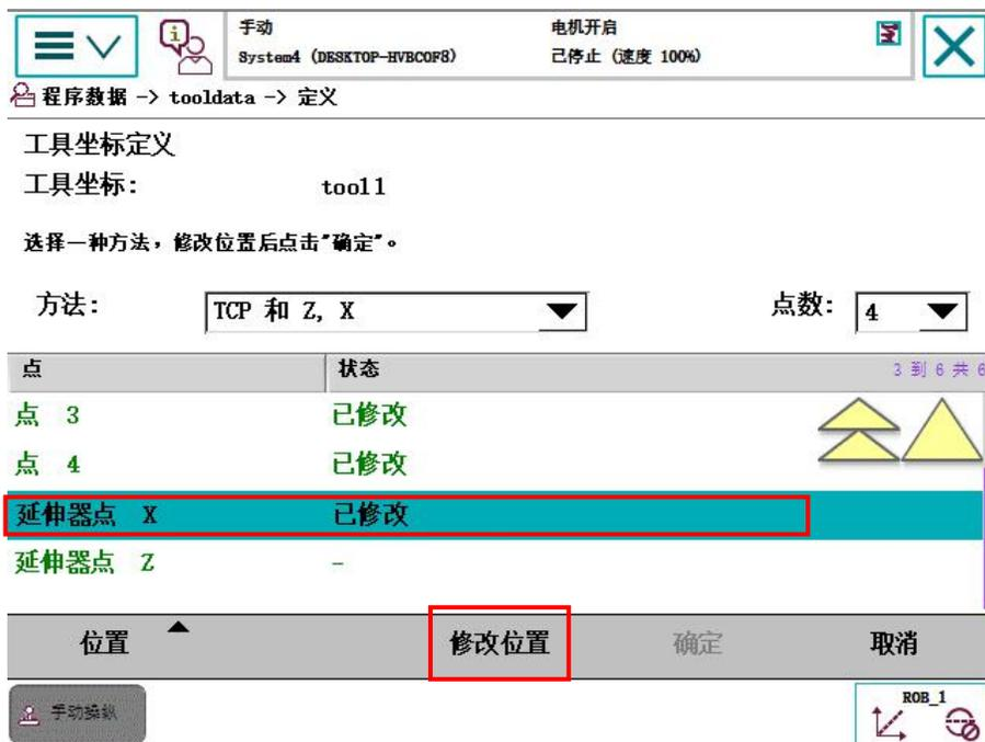
(15) 操纵工业机器人线性运动, 使得参照点成为所需定义的工具坐标系Z轴正向上的某个点。即TCP到固定参照点的方向为+Z。
