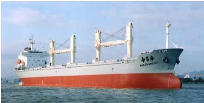
用于装载一般包装、袋装、箱装和桶装的件杂货的船舶。
