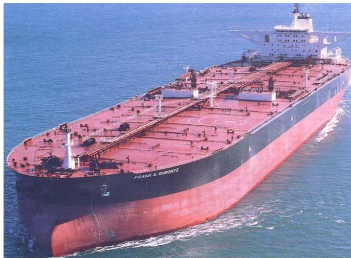
特点是装载量大，一般为单底（发展方向为双层底）；甲板无大的舱口，用泵和管道装卸原油；舱内设有加热设备。
