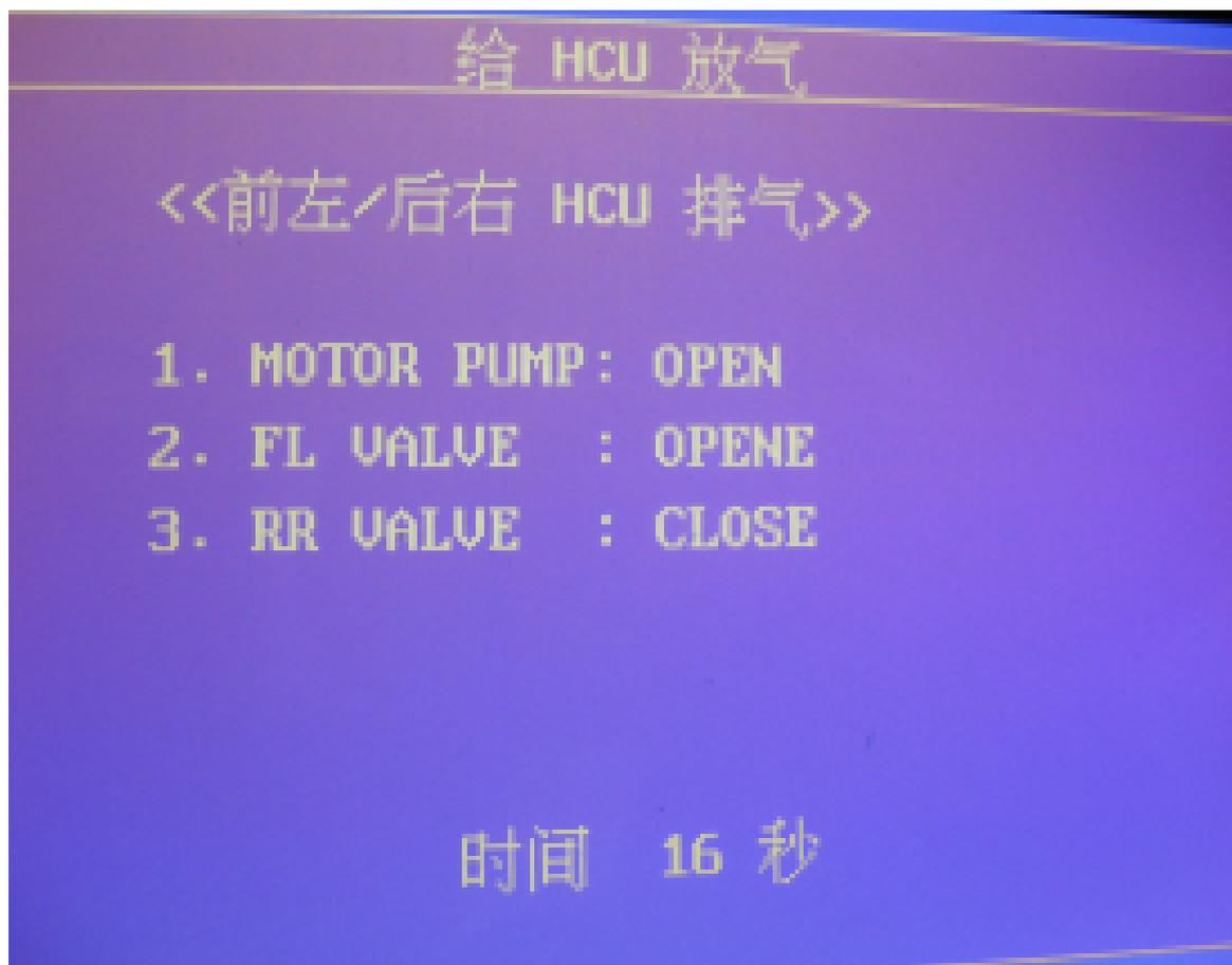
图4-119 解码仪进行排气
