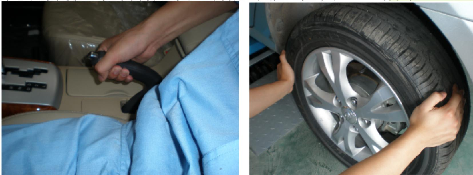
图4-103 检查驻车制动器棘爪的锁定性能
