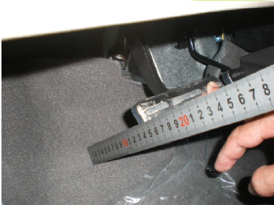
图4-98 测量制动踏板自由行程
