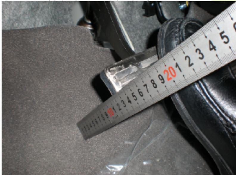
图4-99 测量制动踏板行程
