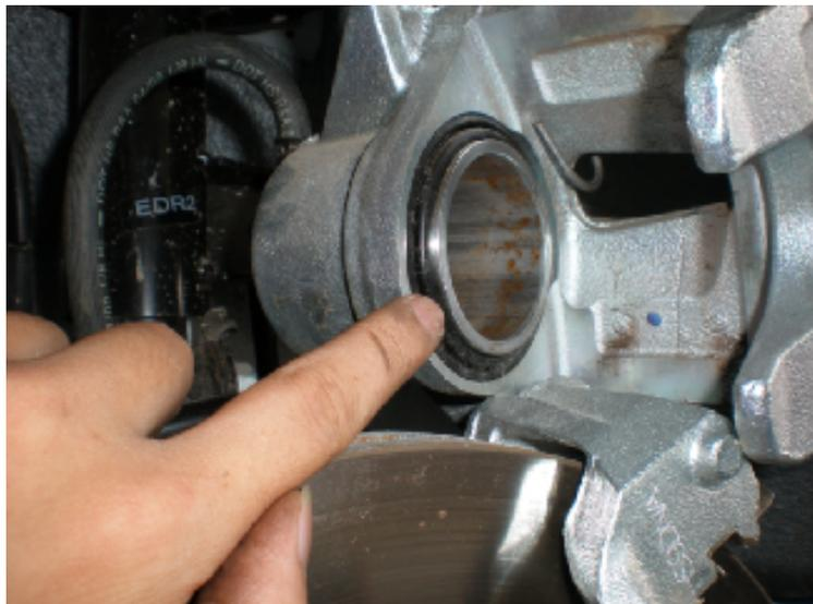
图4-126 目视检查制动卡钳渗漏情况
