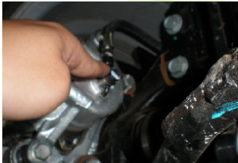
图4-109 检查制动分泵处泄漏情况
