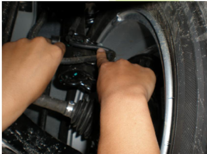
图4-107 检查制动管路老化、损伤情况
