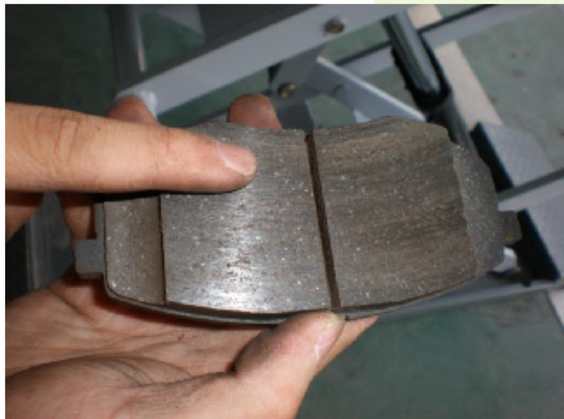
图4-122 制动块外观检查
