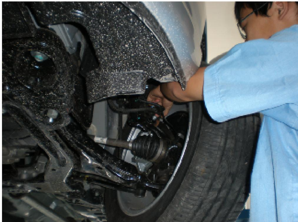
图4-110 观察车轮内侧是否与制动管路发生摩擦或干涉
