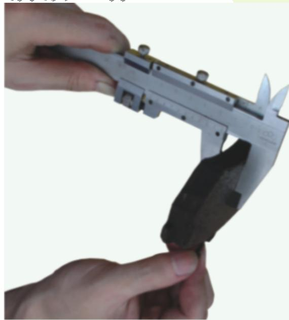
图4-123 检查制动块厚度
