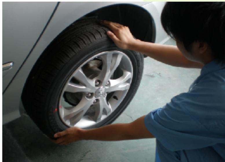
图4-104 检查驻车制动器解除锁定性能
