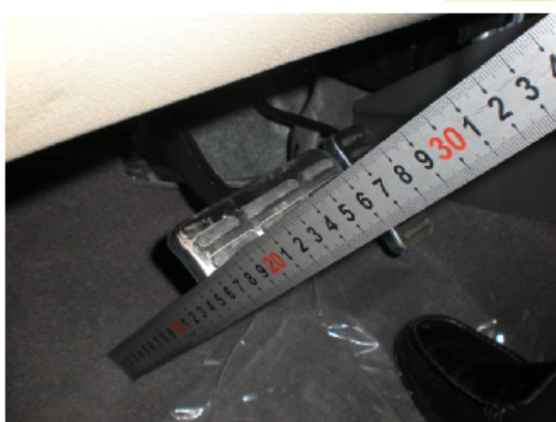
图4-97 测量制动踏板高度
