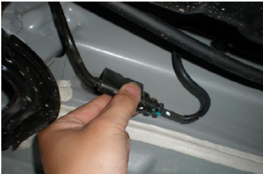
图4-108 检查制动器管道和软管的安装情况
