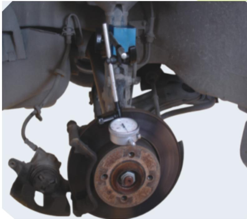
图4-125 制动盘跳动量检查
