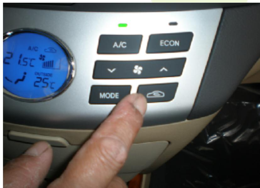
图5-49 按下鼓风机速度控制按钮，检查鼓风机工作情况
