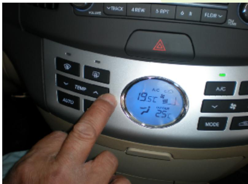
图5-47 按下“**AUTO**”按钮时,图5-48 按下**TEMP**温度控制按钮, 空调工作情况 观察温度变化情况
