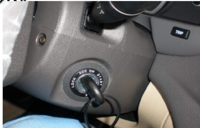
图4-79 点火开关处于ACC位置时方向盘的状态图
