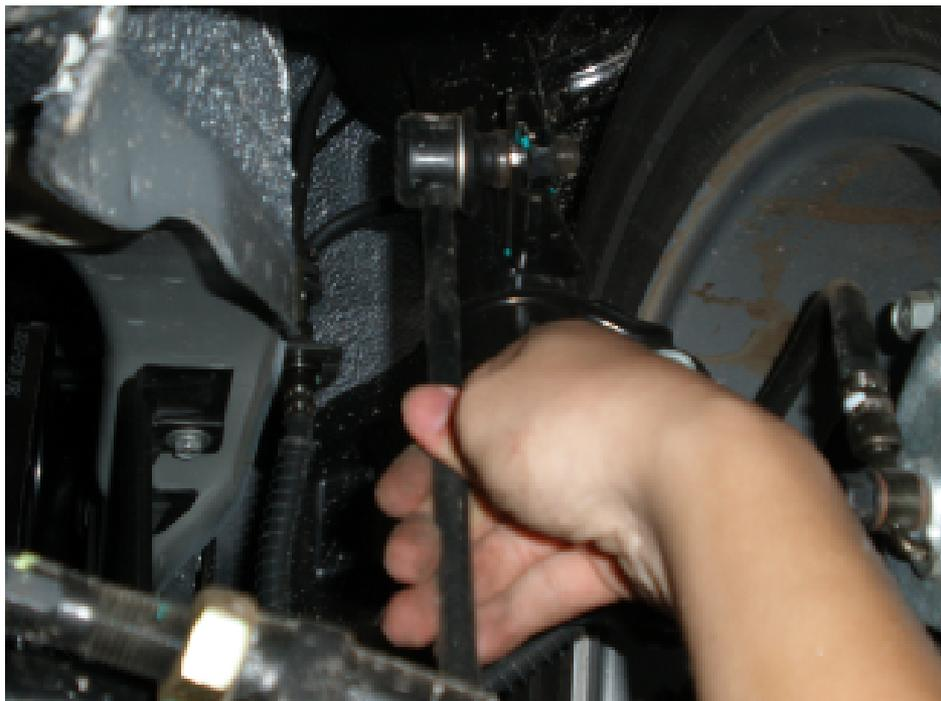
图4-86 检查转向连接机构固定情况
