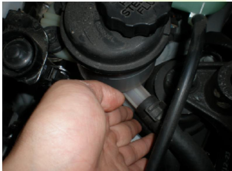
图4-83 连接部位渗漏检查
