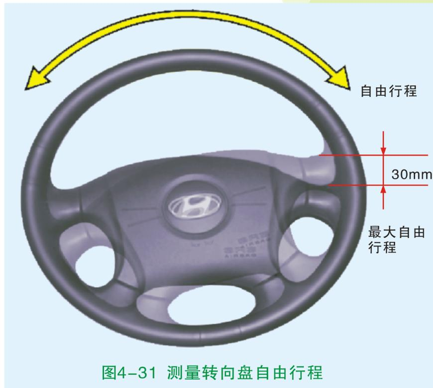
图4-77 方向盘自由行程的检查
