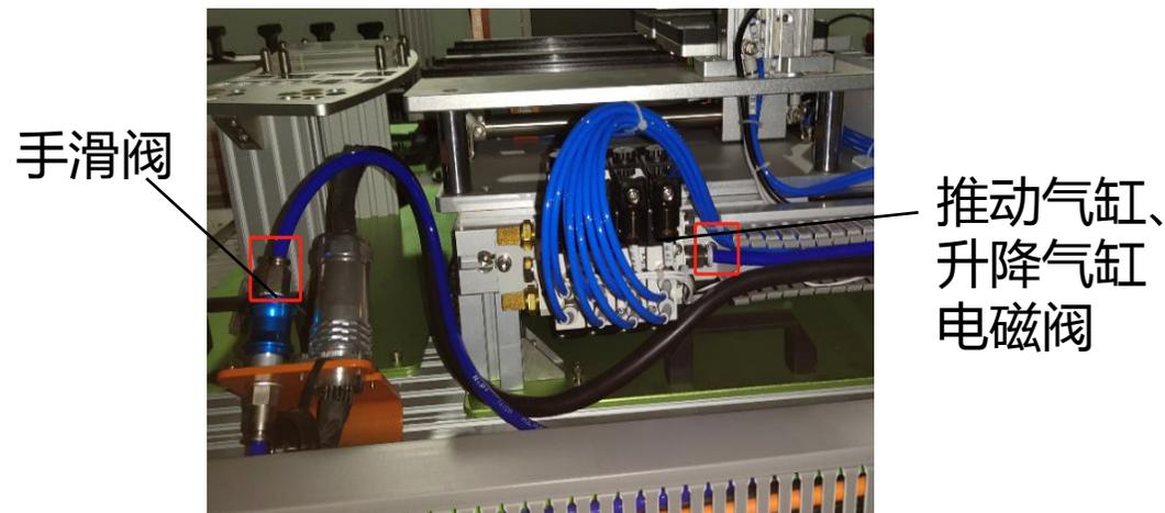
③连接完成后整理气路并盖上线槽盖板。
