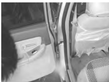
图 7-28 冲洗 B 柱和左后门缝
