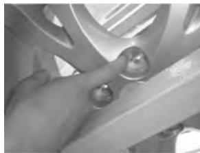
图 5-54 检查轮胎螺栓孔的情况
