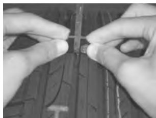
图 5-52 检查轮胎胎面花纹沟槽深度
