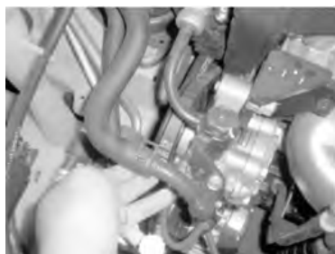
图 5-88 检查动力转向泵是否渗漏
