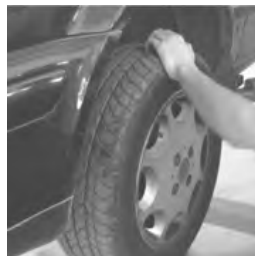
图 5-55 检查车轮是否摆动、转动是否良好且无噪声
