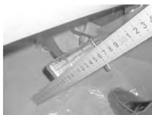
图 5-101 测量制动踏板高度
