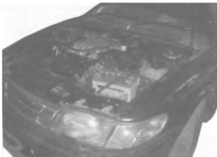
图 3-12 检查蓄电池接线柱与电缆
