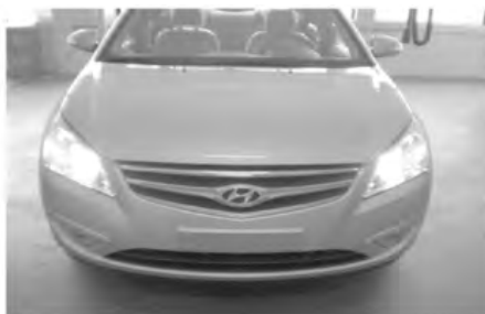
图 6-10 灯光控制开关置于远光灯位置， 远光灯工作情况的检查
