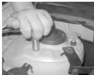
图 5-72 紧固左、右前减振器座螺栓
