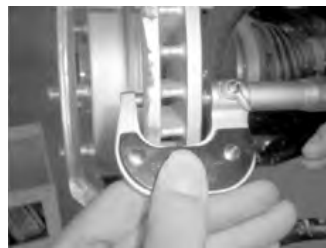
图 5-127 前制动盘厚度检查
