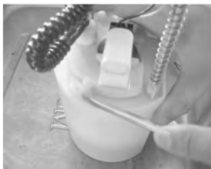
图 4-30 拆卸储液罐盖
