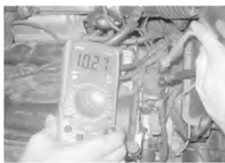
图 4-46 测量点火线圈二次绕组的电阻值
