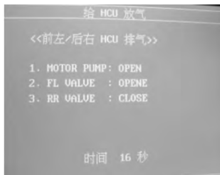
图 5-122 解码仪进行排气
