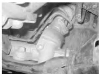
图 5-77 紧固转向机外壳至横梁的固定螺栓
