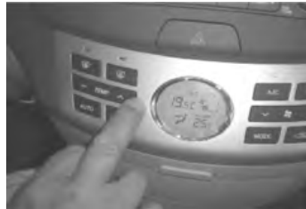
图 6-44 按下 TEMP 温度控制按钮,观察温度变化情况
