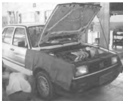
图 3-7 检视车辆泄漏现象
