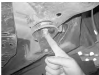
图 5-75 紧固车架装配螺栓
