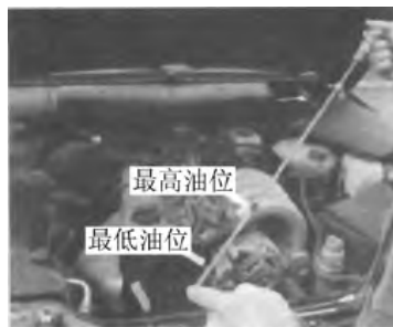
图 3-4 检视各液面高度
