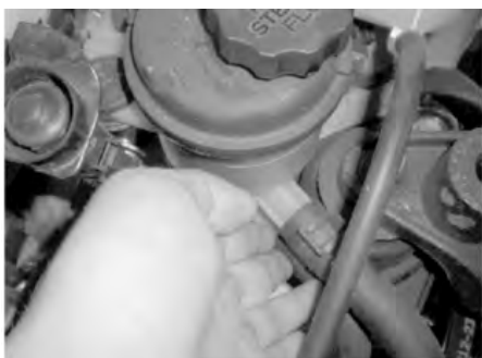
图 5-90 检查连接部位是否渗漏
