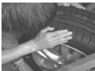
图 5-49 检查胎侧及胎肩情况
