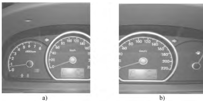
图 6-36 转向指示灯的检查
