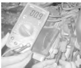
图 4-45 测量点火线圈一次绕组的电阻值
