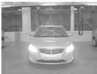
图 6-10 灯光控制开关置于远光灯位置， 远光灯工作情况的检查
