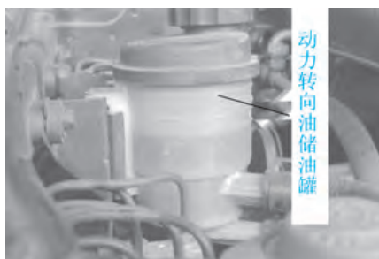
图 5-87 检查动力转向油液位
