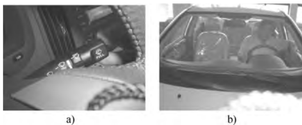
图 6-56 检查刮水器在停止位置时的情况
