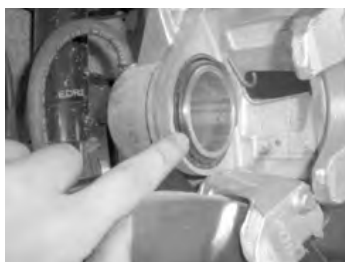
图 5-129 目视检查制动卡钳渗漏情况
