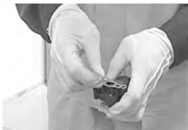
图 4-9 更换密封垫片
