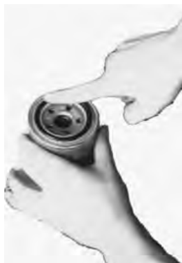
图 4-53 在新机油滤清器的 O 形环上涂抹润滑油
