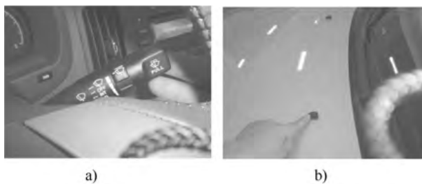
图 6-52 检查喷水器喷嘴堵塞情况
