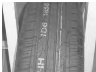
图 5-51 检查轮胎胎面磨损情况
