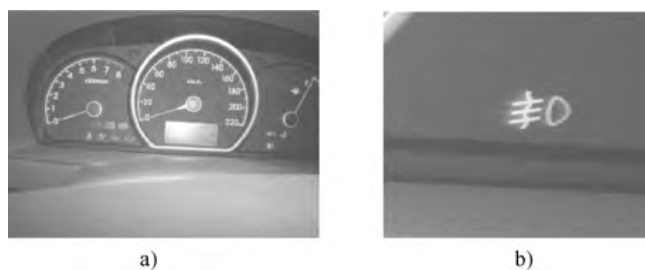
图 6-37 前后雾灯指示灯的检查
