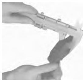
图 5-126 检查制动块厚度
