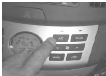
图 6-42 检查按下 A/C 按钮时,空调工作情况
