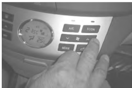
图 6-45 按下鼓风机速度控制按钮, 检查鼓风机工作情况
