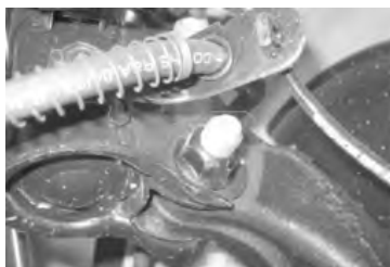
图 5-81 紧固支柱总成到转向节螺栓
