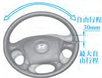
图 5-83 转向盘自由行程的检查
