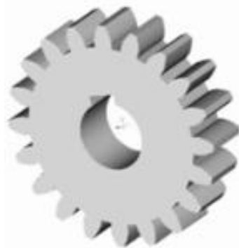
图 5-1 直齿圆柱齿轮
