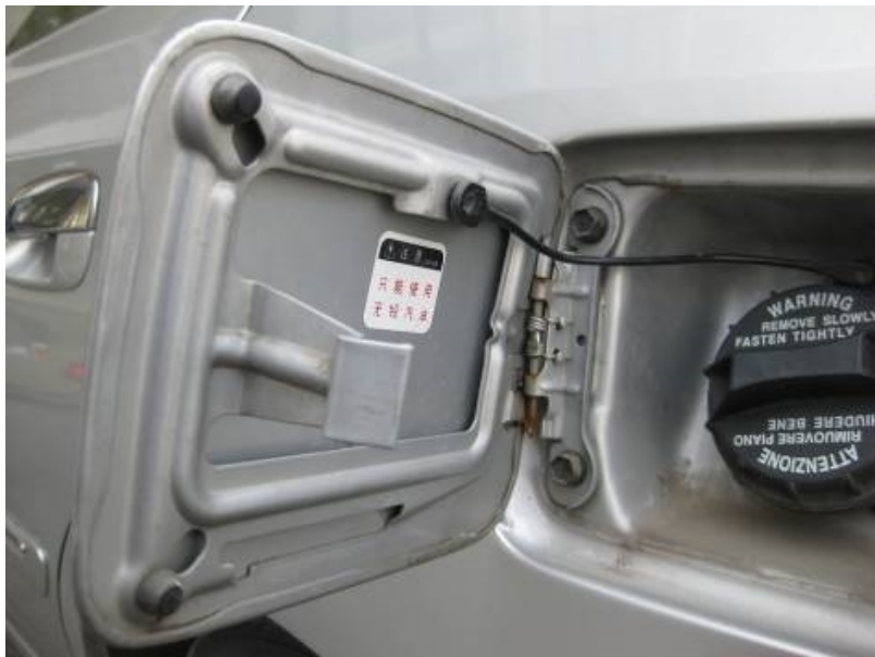
图6-73 燃油箱盖检查
