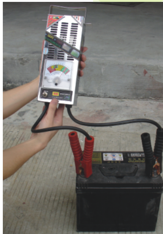
图5-4 蓄电池电压检测
