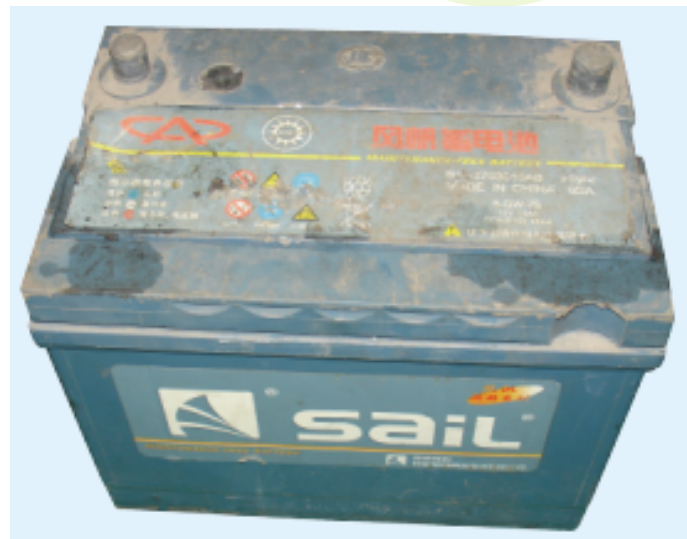
图5-2 蓄电池外观检查
